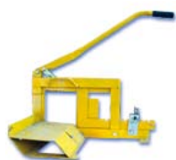
Blockklippare. Används för att kapa massiva lättklinkerblock.
