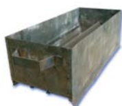
Murbrukslåda. Används för att rationellt applicera strängar med murbruk på lättklinkerblock.
