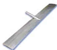
Sloda. Sitter monterad på ett långt skaft och används till att göra en grov avjämning av ytan vid golvgjutning.
